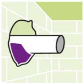
Voor het vullen van leidingdoorvoeren.
