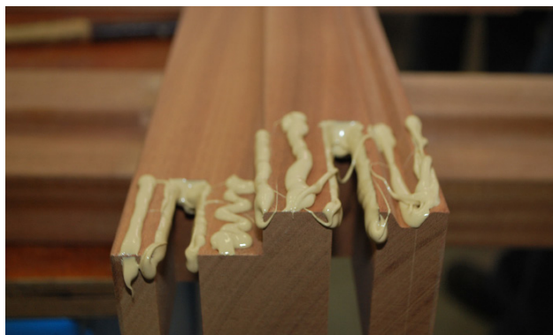
Figuur 5. Aanbrengen lijmrillen op de dorpel van een slis verbinding.
