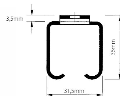
Het profiel ref. 110.200 is het profiel ref. 110.000 met doorzette plafondplaatjes. Via deze plaatjes wordt het profiel rechtstreeks aan het plafond vastgeschroefd. Door deze doorzetting kunnen de vijskoppen de loop van de rollen nooit hinderen. Wanneer toch muurbevestiging gewenst wordt, kunnen de hoeken ref. 111.170 in de gleuf tussen profiel en plafondplaat worden ingedrukt.
